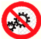
Vietato rimuovere le protezioni
